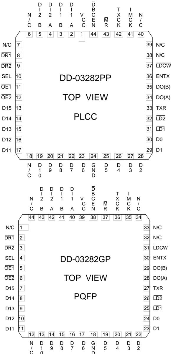
FIGURE 2. DD-03282 PIN-OUT
