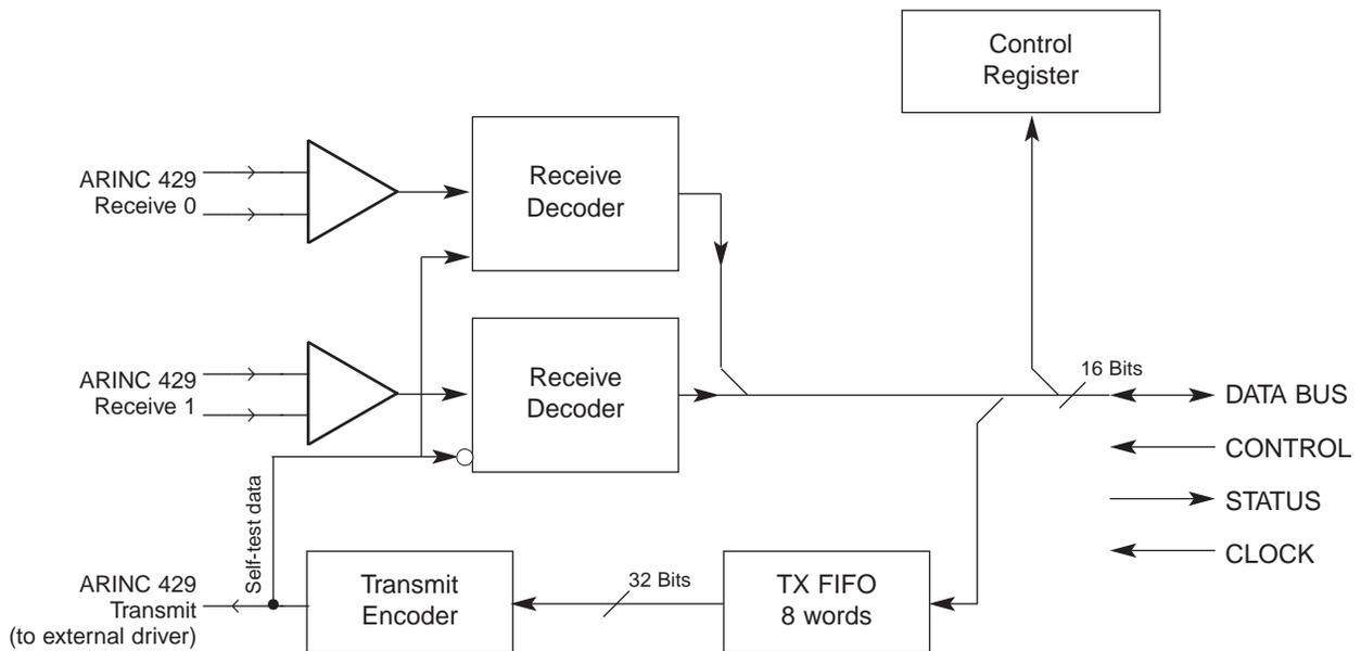
**FIGURE 1. DD-03282 BLOCK DIAGRAM**
